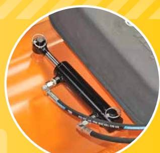
2 WINKELVERSTELL- UND BEHÄLTERLEERZYLINDER ANGULAR ADJUSTMENT – AND DUMP CYLINDER VERIN D'ORIENTATION ET DE VIDAGE DU BAC A POUSSIERE
